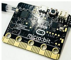
Cette carte embarque un microcontrôleur qui est un système complet tenant dans une seule puce : SoC (System on Chip). On y trouve de la mémoire RAM, de la mémoire Flash, un microprocesseur, des périphériques d'interface, un circuit radio.
