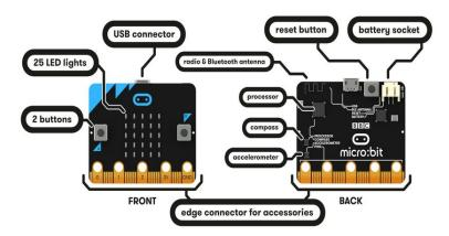
Identifier à partir de ce schéma tous les capteurs et actionneurs mis à disposition sur la carte micro :bit.
